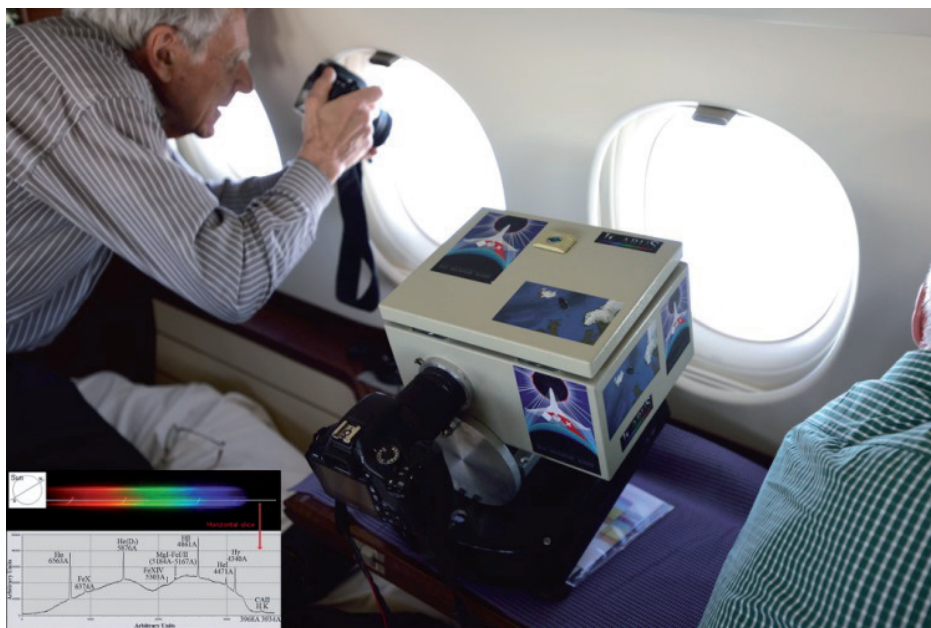
Φωτό 15: ο φασματογράφος “Icarus” εγκατεστημένος στο αεροπλάνο Falcon 7X
