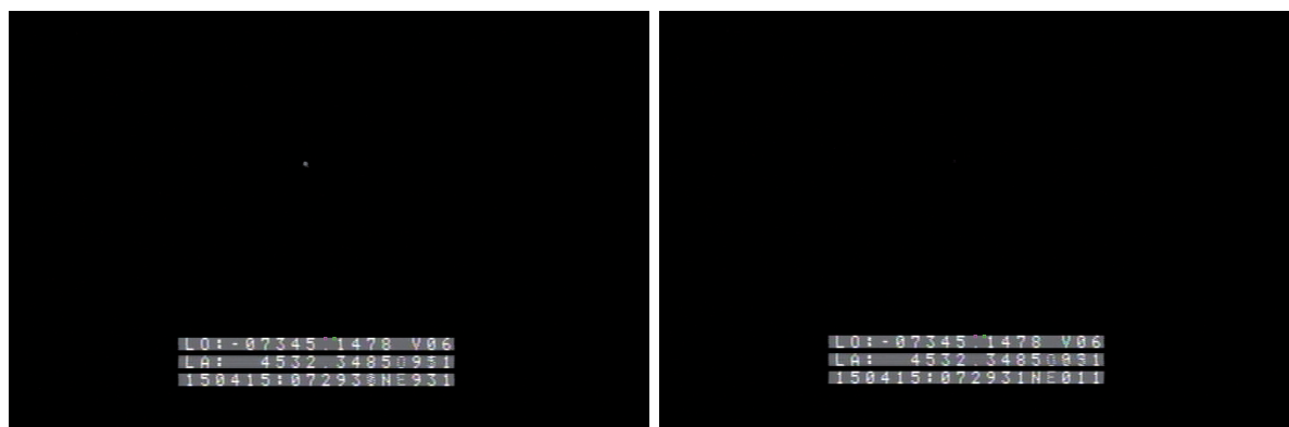
Εικ. 4: Χρήση βίντεο 25 fps με αποτύπωση χρόνου GPS και LAT – LON σε κάθε καρέ (frame). Δύο καρέ, αμέσως πριν και αμέσως μετά την απόκρυψη.
