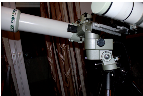
Φωτό 2: η τροποποιημένη ισημερινή στήριξη με τα δύο συζυγή τηλεσκόπια
