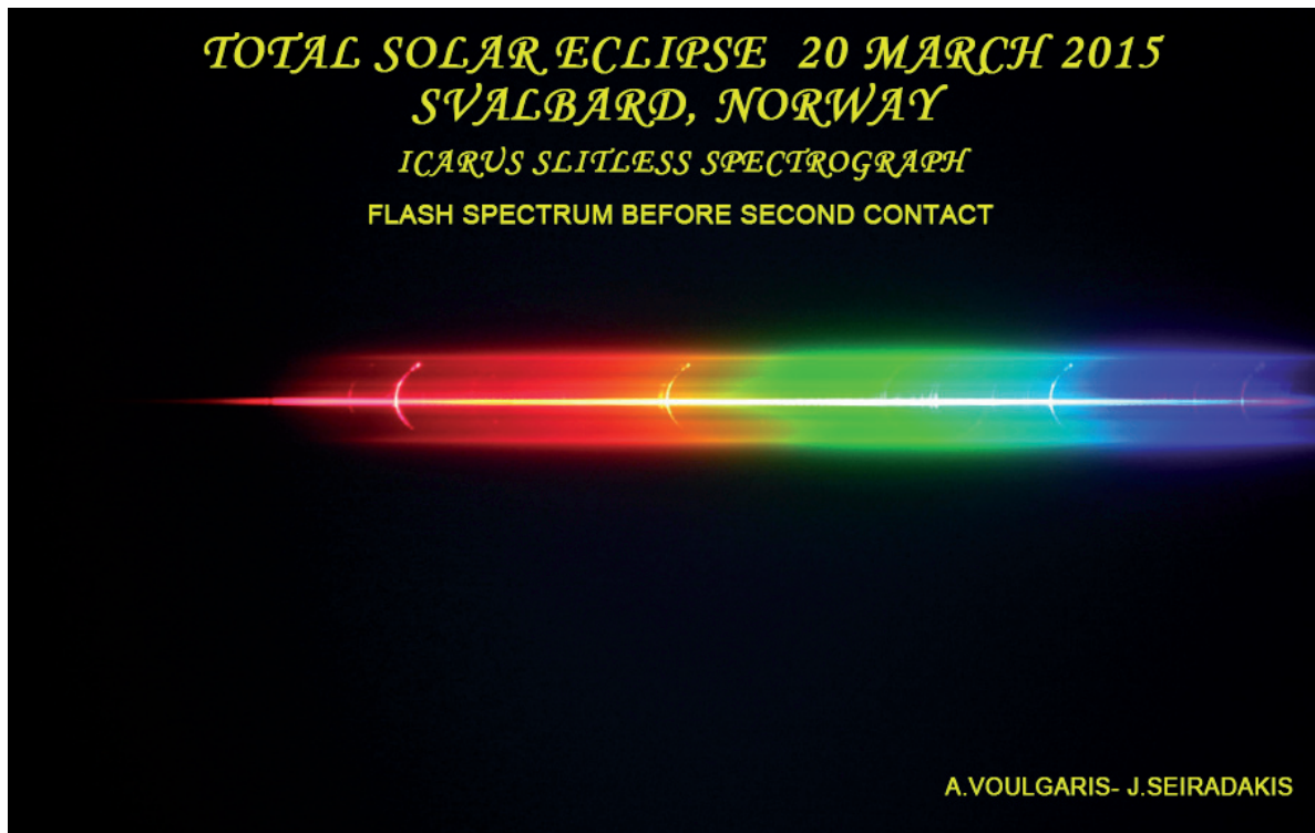
Φωτό 13: Το στιγμιαίο φάσμα όπως το κατέγραψε ο φασματογράφος άνευ σχισμής λίγο πριν την έναρξη της ολικότητας
