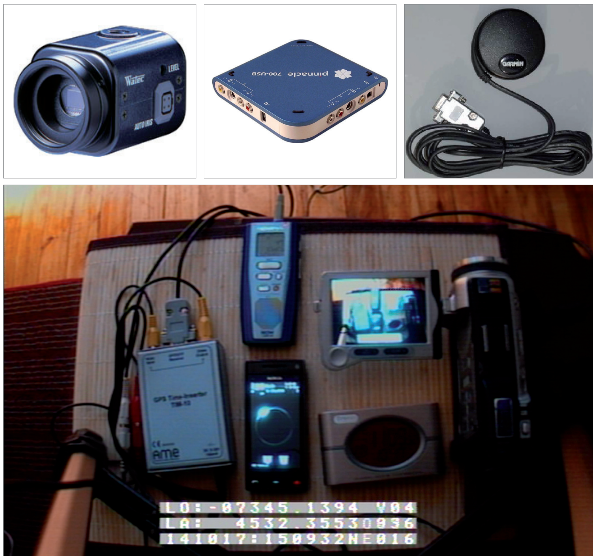
Εικ. 2: Πάνω αριστερά: Η κάμερα WATEC 902 H2 Ultimate. Κέντρο: η συσκευή ψηφιοποίησης Pinnacle 700-USB. Πάνω δεξιά: η μονάδα GPS Garmin OEM-18 LVC.
