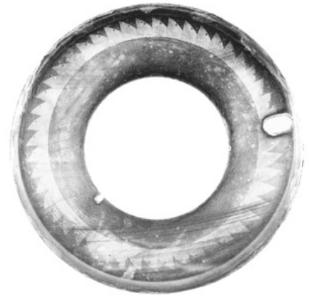
Ο δίσκος με τις Δαγκεροτυπίες που ετοποθετείτο στο εσωτερικό του Φωτογραφικού Revolver. Διακρίνονται λήψεις κατά τη φάση της Εισόδου (Ingress).
