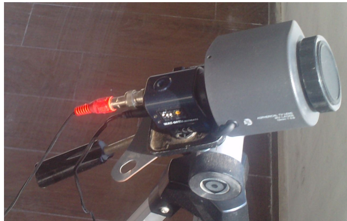
Εικόνα του συστήματος της Watec με τον φακό Panasonic (ο υπολογιστής που δεν φαίνεται “τρέχει” το MetRec).
